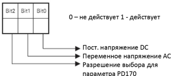
Для заводской настройки (0) отображаются на дисплее: выходная частота, заданная частота, выходной ток и число оборотов поочередно с помощью клавиши пульта ПЧ. Если необходимо просматривать и контролировать другие элементы, их можно установить с помощью PD170 и PD171.
