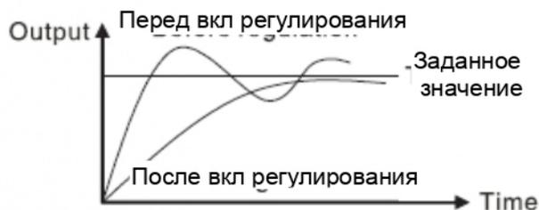
Подавление переупруглирования на выходе
