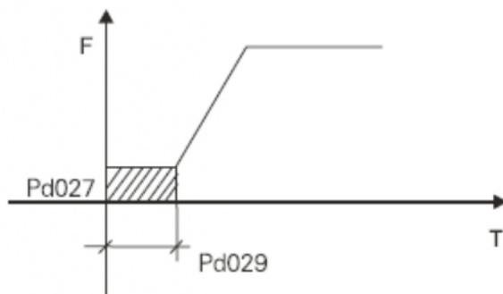
Этот параметр установлен для торможения постоянным током при запуске и Длительность торможения постоянным током. Если она =0,
