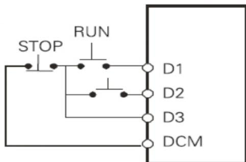
1: Три многофунк. входа подключаются по Трехпроводной системе для реализации переключения направл. вращения FOR/REV, которая широко применяется в случае установки фотоэлектрич. датчиков.
