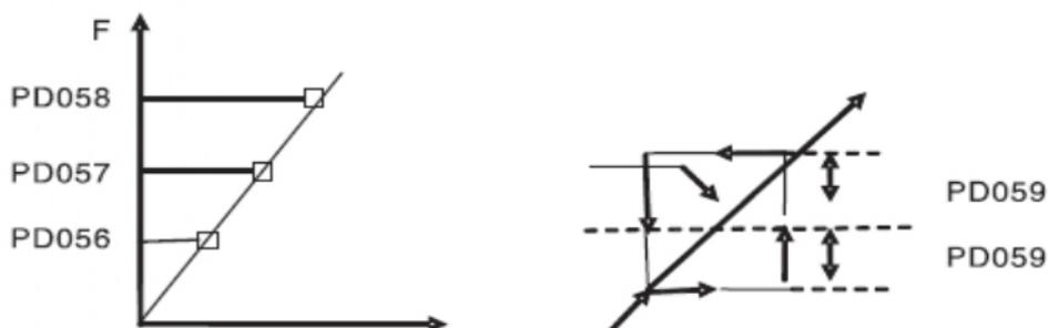
Эти три точки частоты пропуска установлены для исключения механического резонанса. В случае PD059 = 0 все частоты пропуска не допустимы. Фактический диапазон полосы частота пропускания в два раза выше, чем у PD059, как показано на диаграмме выше.
