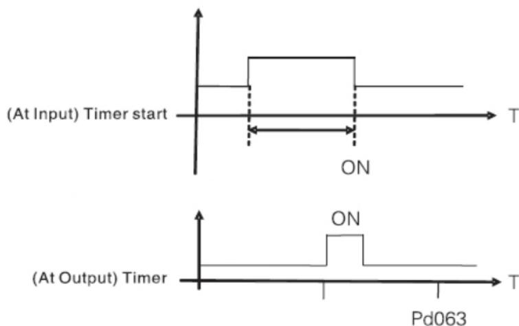
Например, задано PD063=5сек. Если внешний контакт на мультифунк. Входе замкнут, то через 5 сек сработает соответствующий контакт выхода, этот сигнал можно использовать для управления другими сигналами.
